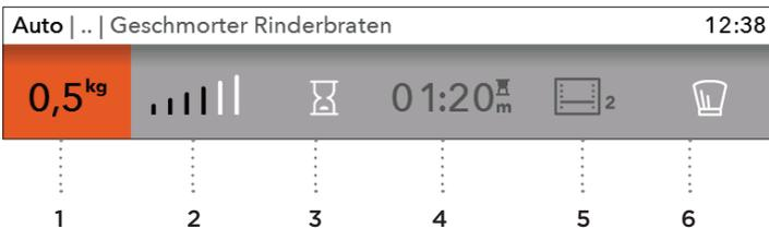
Es werden die voreingestellte Werte angezeigt: Sie können die Menge, die Bräunungsstufe und die Einschaltverzögerung (Betriebsende) einstellen.
