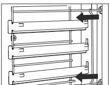
**2** Nehmen Sie die Führungen aus den Bohrungen der Rückwand heraus.
