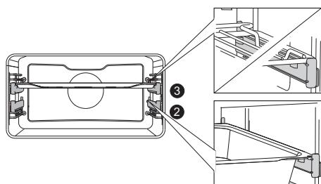
⚠ Schließen Sie die Gerätetür erst dann, wenn die Teleskopausziehführungen bis zum Anschlag eingeschoben sind.
