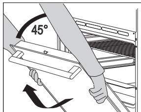
**3** Schließen Sie langsam die Gerätetür bis zum Winkel 45° (hinsichtlich der geschlossenen Position der Tür), heben Sie sie leicht an und ziehen Sie sie in Ihrer Richtung heraus.
