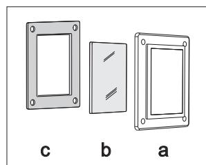
Auf der Abdeckung ist eine Dichtung angebracht, die Sie nicht entfernen dürfen bzw. darf diese nicht deformiert sein. Die Dichtung muss gut an der Wand des Garraums anliegen.
