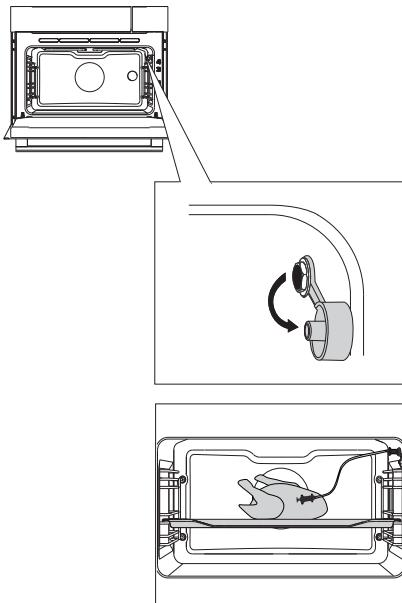
**1** Entfernen Sie den Metallzapfen (die Steckdose befindet sich in der oberen rechten Ecke des Garraums).
