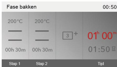
5. Door opnieuw op de 'start/stop'-toets (05) te drukken, begint de oven te werken volgens stap 1 (geselecteerde stap wordt in rood weergegeven). Wanneer de ingestelde tijd voorbij is, wordt de volgende stap geactiveerd, d.w.z. stap 2, en later stap 3, als u deze gekozen zou hebben.
