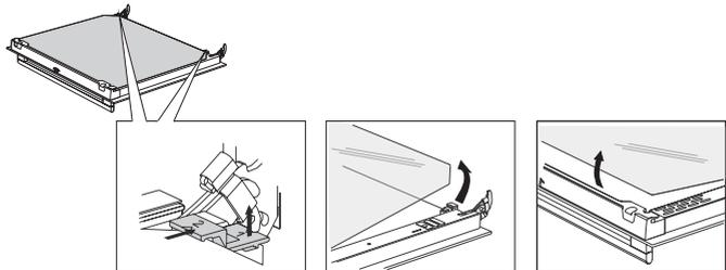
Setzen Sie das Glas in umgekehrter Reihenfolge wieder ein. Die Markierungen auf der Ofentür und dem Glas (ein Halbkreis) müssen zusammenpassen.
