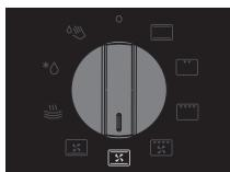
Bovenwarmte en onderwarmte en ventilator
