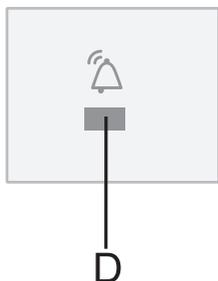
Bei überhöhter Temperatur im Geräteinneren schaltet sich ein Alarm ein (das Indikatorlämpchen **D** blinkt). Wenn der Gefrierteil ausreichend abgekühlt ist und keine Gefahr besteht, dass die Lebensmittel verderben, schaltet sich das Indikatorlämpchen automatisch aus.
