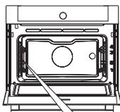
**Vissez fermement les vis du couvercle à l'aide d'un tournevis. Autrement, des étincelles pourraient se produire.**
