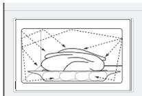
Les micro-ondes sont des ondes électromagnétiques à haute fréquence. L'énergie libérée permet de cuire ou de réchauffer des aliments sans qu'ils ne changent de forme ou de couleur.
