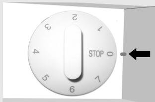
Pour mettre l'appareil en marche, tournez le bouton du thermostat sur une position quelconque entre 1 et 7. Pour l'arrêter, réglez-le sur STOP (0).
