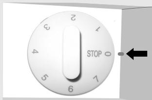
U regelt de werking van de koelkast met de thermostaatknop (zie afbeelding). U schakelt het apparaat in door de thermostaatknop op een stand tussen 1 en 7 te zetten. Zet hem op STOP (0) om het apparaat uit te schakelen.
