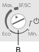
U schakelt het apparaat in door de knop (B) in de richting van **Max** te draaien. U schakelt het apparaat uit door de pijl (driehoekje) op de knop bij het AAN/UIT-teken
