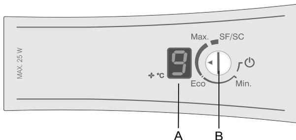
**A Thermomètre à affichage numérique (uniquement sur certains modèles) :** indique la température réelle du réfrigérateur de +1°C à +9°C.
