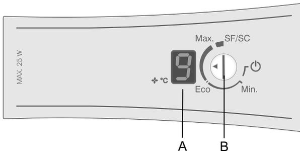
**A Die digitale Temperaturanzeige** des Kühlschranks (nur bei einigen Modellen) zeigt die tatsächliche Temperatur im Geräteinneren von +1° C bis +9° C während des Betriebs an.
