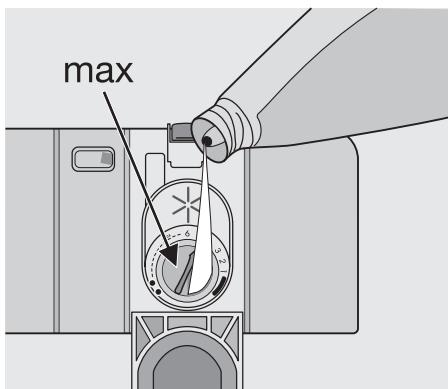
Le distributeur contient environ 110 ml de liquide de rinçage, quantité suffisante pour 16 à 40 cycles de lavage, en fonction du réglage de la dose programmée.
