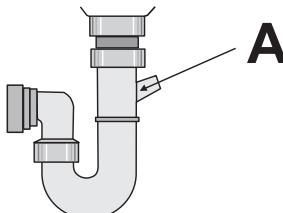
**i** Unsere Geräte verfügen über eine Sicherheitseinrichtung, die den Rückfluss von Schmutzwasser in die Maschine verhindert. Falls der Siphon Ihrer Spüle mit einem "Rückschlagventil" ausgestattet ist, kann dadurch der Ablauf Ihres Geschirrspülers beeinträchtigt werden. Sie sollten das Ventil daher entfernen.
