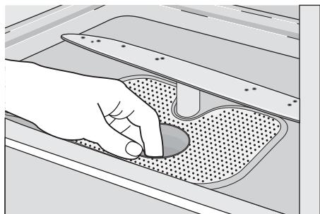
7. Plaats het platte filter terug in de bodem van het afwascompartment en controleer of het filter goed op zijn plaats zit.
