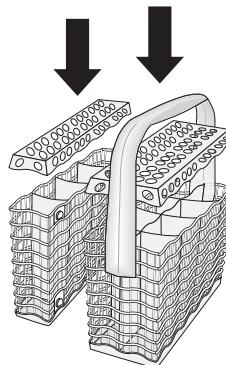
Der Besteckkorb besteht aus zwei Teilen, die bei Bedarf getrennt werden können. Schieben Sie die beiden Hälften zum Trennen in entgegengesetzte Richtungen und ziehen Sie sie dann auseinander.
