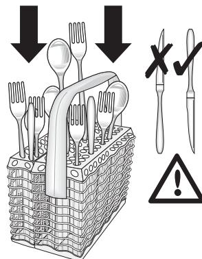
Als de handgrepen onder de bestekmand uitsteken en de onderste sproeiarm in zijn beweging belemmeren, dient het bestek met de handgrepen omhoog te worden geplaatst.
