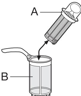
3. Drehen Sie den Griff um 1/4 Umdrehung nach links und ziehen Sie das Filtersystem heraus
