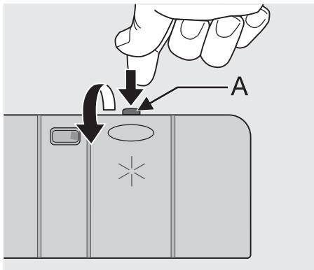
2. Füllen Sie das Klarspülmittel in den Behälter. Der maximale Füllstand wird durch die Markierung "max" angezeigt.
