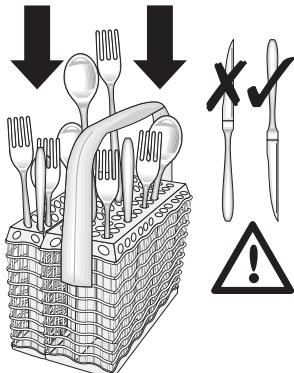
Falls die Griffe auf der Unterseite aus dem Korb ragen und den unteren Sprüharm behindern, das Besteck mit nach oben gerichtetem Griff laden.
