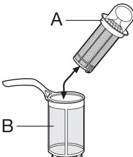
3. Draai de greep ongeveer een kwartslag naar links en verwijder het filtersysteem
