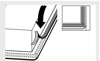
Plak het afdichtband niet door de hoek, maar knip vier stukken die in de hoeken goed op elkaar aansluiten.
