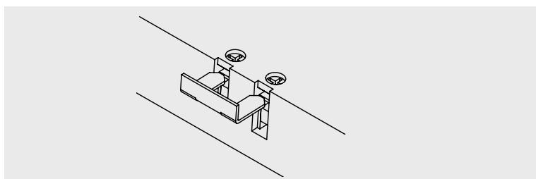
Zet de kabel vast met de trekontlasting en sluit het deksel.
