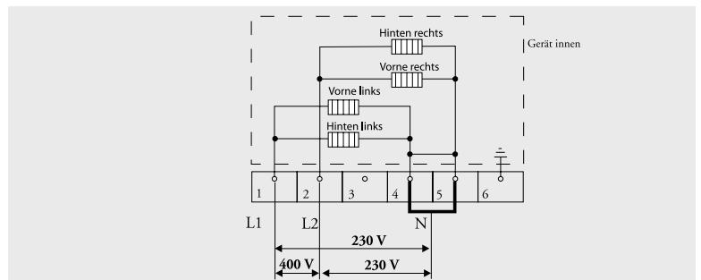
**3-Phasen-Netzanschluß mit 1 Nullleiter (3 1N Wechselstrom 400 V / 50 Hz):**
