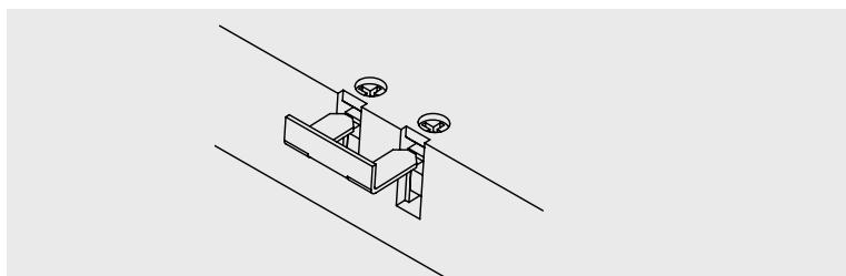
Attachez le câble en utilisant le dispositif de délestage. Fermez ensuite le couvercle.
