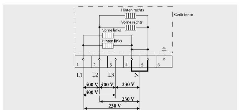
**3-Phasen-Netzanschluss (3 Phasen Wechselstrom 230 V / 50 Hz):**
