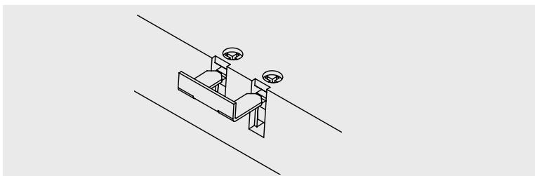
Befestigen Sie das Kabel mit der Zugentlastung und schließen Sie den Deckel.
