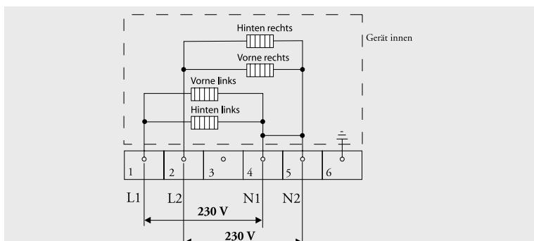
**2-Phasen-Netzanschluß mit 1 Nullleiter (2 1N Wechselstrom 400 V / 50 Hz):**
