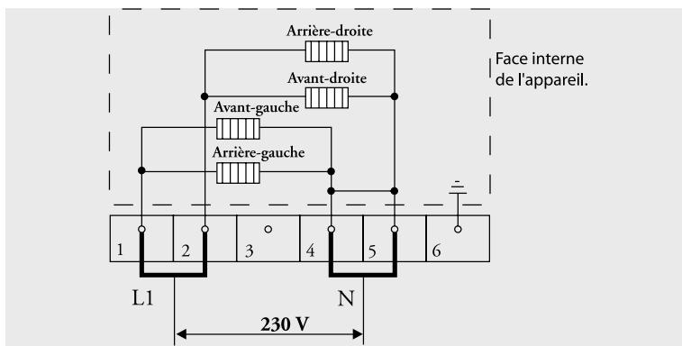
**Connexion 2 phases avec 2 neutres (2 2N a.c. 230 V / 50 Hz):**
