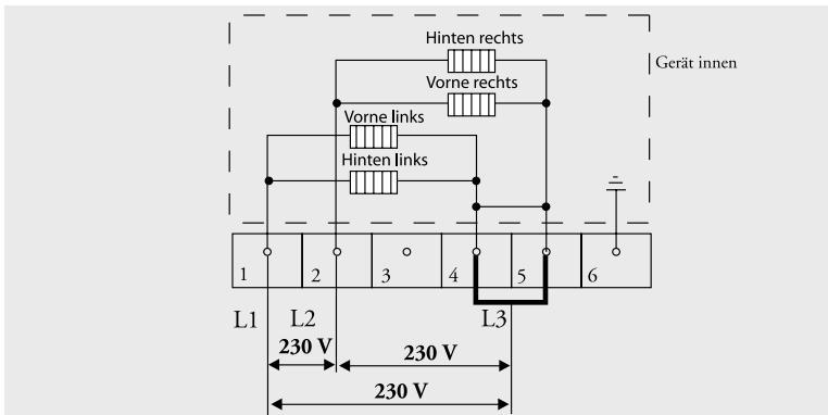
Mit den auf der Anschlussleiste vorhandenen Brücken können die erforderlichen Verbindungen hergestellt werden, wie in obigen Illustrationen angegeben. Im Deckel des Anschlusskastens und in untenstehender Illustration ist angegeben, wie die Brücken anzubringen sind. Sie sind nicht unmittelbar über den Anschlussdrähten anzubringen, sondern zwischen dem Schraubenkopf und der Klemme um den Anschlussdraht.
