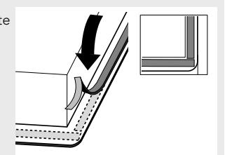
Kleben Sie das Dichtungsband nicht über die Ecken hinaus, sondern schneiden Sie vier Stücken, die in den Ecken einwandfrei anschließen.
