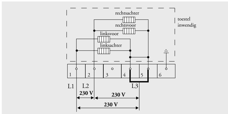
Met de op het aansluitblok aanwezige bruggen kunt u de vereiste doorverbindingen maken zoals in voorgaande illustraties staat aangegeven. In het deksel van het aansluitkastje en in onderstaande illustratie staat aangegeven hoe u de bruggen aan moet brengen. Deze moeten niet meteen bovenop de aansluitdraden worden geplaatst, maar tussen de schroefkop en de klem om de aansluitdraad.
