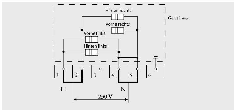
**2-Phasen-Netzanschluß mit 2 Nulleitern (2 2N Wechselstrom 230 V / 50 Hz):**
