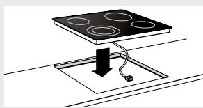
Fixez la plaque de cuisson à l'aide des bornes remises avec la livraison. En cas de plans de travail plus fins que 40 mm, utilisez un bloc de garniture entre les bornes et le plan de travail. Vissez les vis dans les trous bosselés.
