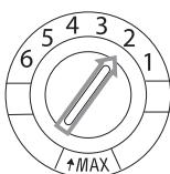
Het glansspoelmiddelreservoir heeft 6 standen. Stel het reservoir in eerste instantie in op stand 2. Indien er in dat geval vlekken op het vaatwerk blijven ontstaan en de vaat niet goed droogt vergroot u de hoeveelheid glansspoelmiddel door de keuzeknop van het reservoir op stand 3 te draaien. Als dat geen verbetering geeft stelt u de keuzeknop in op een hogere stand. Herhaal deze handeling totdat de vaat streeploos droog uit de machine komt.
