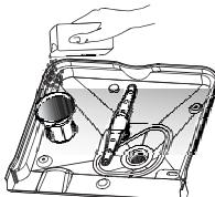
Diese Maschine ist mit einem Wasserenthärter ausgestattet. Füllen Sie hierzu den Geschirrspüler mit Salz.
