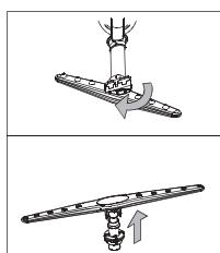
Die Sprüharme müssen regelmäßig gereinigt werden. Verschmutzung verstopft auf Dauer die Sprühköpfe und die Lager der Sprüharme. Reinigen Sie die Sprüharme folgendermaßen:
