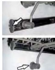
Le panier supérieur peut être réglé en hauteur en retirant le panier et en plaçant les rails de guidage dans une autre position.
