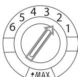
Le réservoir de liquide de rinçage a 6 positions. Réglez en premier lieu le réservoir sur la position 2. Si des taches continuent d'apparaître sur la vaisselle, et si la vaisselle ne sèche pas bien, augmentez la quantité de liquide de rinçage en tournant le bouton du réservoir sur la position 3. Si cela n'entraîne aucune amélioration, réglez le bouton sur une position supérieure. Répétez cette opération jusqu'à ce que la vaisselle sorte sèche et sans traces de la machine.
