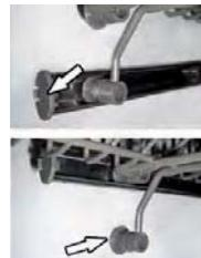
Der obere Korb kann in der Höhe verstellt werden; hierzu den Korb herausnehmen und in anderer Stellung in die Führungsschienen einsetzen.
