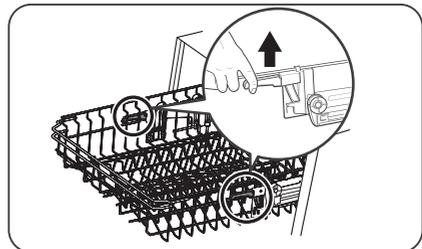
1. Um den Korb auf seine obere Position einzustellen, Korb anheben, bis sich beide Seiten auf der gleichen Höhe befinden. Der Korb rastet ein.
