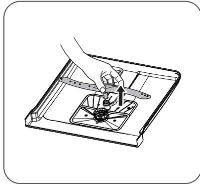
1. Um den oberen Sprüharm zu lösen, Mutter festhalten und Arm im Uhrzeigersinn drehen.
