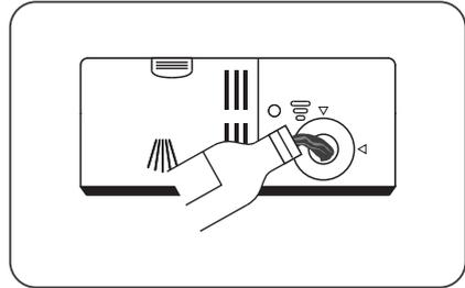
1. Um die Kammer zu öffnen, Deckel zum Pfeil „geöffnet“ drehen (links). Nach oben abheben.
