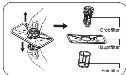
1. Schrauben Sie den Grobfilter entgegen dem Uhrzeigersinn lose. Ziehen Sie den Filter nach oben heraus.
