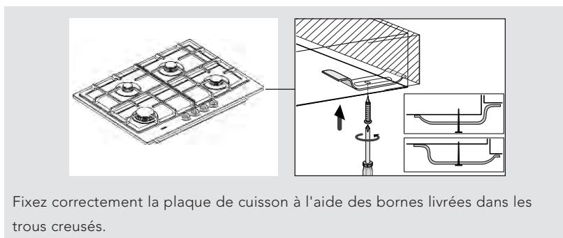
Fixez correctement la plaque de cuisson à l'aide des bornes livrées dans les trous creusés.
