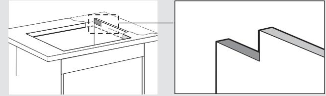
Maak een uitsparing in de zijwand van de keukenkast voor het doorvoeren van de gasleiding en het aansluitsnoer.
