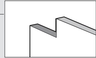
Eine Aussparung in der Seitenwand des Küchenschrankes zum Durchführen der Gasleitung und elektrischen Anschluß aussägen.
