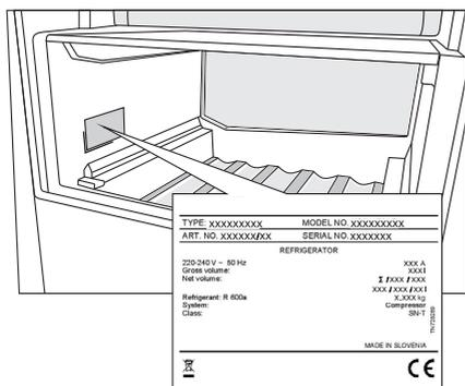
La plaque signalétique est apposée à l'intérieur de l'appareil. Elle indique la tension, le poids brut et net, le type et la quantité de réfrigérant et les classe climatiques. Si elle n'est pas dans la langue de votre choix ou celle de votre pays, collez par-dessus l'étiquette adhésive jointe.
