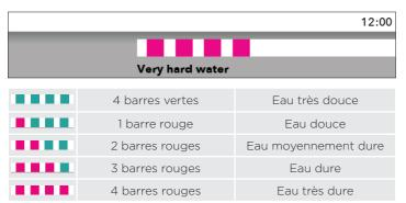
Trempez dans l'eau une bandelette de papier réactif (fourni avec l'appareil) pendant une (1) seconde. Attendez une minute, puis comptez le nombre de barres sur le papier. Entrez le nombre de barres dans l'appareil. Tournez le BOUTON.
