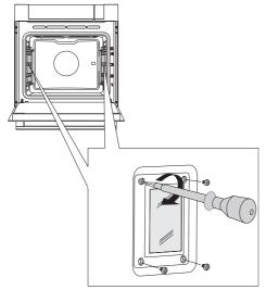
Dévissez les 4 vis du couvercle. Enlevez le couvercle, la vitre et le joint d'étanchéité.
