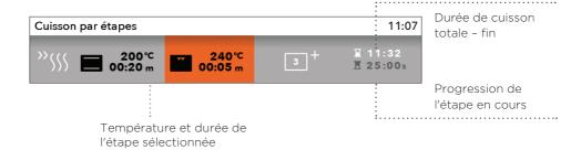
Effleurez la touche DÉPART pour lancer la cuisson. Le four démarre immédiatement avec les réglages de l'étape 1 (une barre en bas de l'écran indique la progression de l'étape en cours). Lorsque le temps de cuisson défini pour l'étape 1 s'est écoulé, les réglages de l'étape 2 sont activés, puis ceux de l'étape 3 si vous les avez spécifiés.
