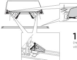
Soulevez légèrement les supports situés sur les côtés droit et gauche de la porte (repère 1 sur le support) et retirez-les de la vitre (repère 2 sur le support).
