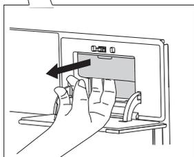
**2** Verwijder de watertank uit de behuizing door aan het verzonken gedeelte te trekken.
