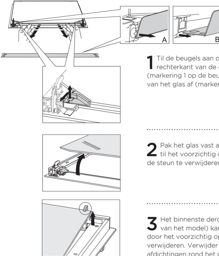
**1** Til de beugels aan de linker- en rechterkant van de deur een beetje op (markering 1 op de beugel) en trek deze iets van het glas af (markering 2 op de beugel).
