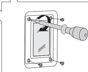
**1** Draai de vier schroeven van het afdekplaatje los. Verwijder het afdekplaatje, het glas en de afdichtring.
