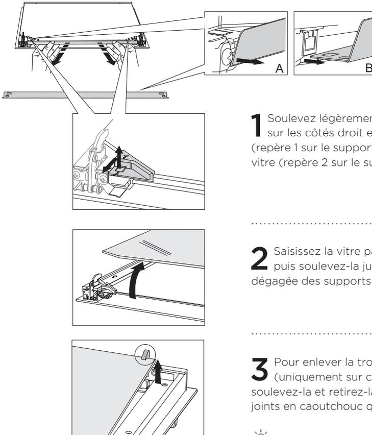
**1** Soulevez légèrement les supports situés sur les côtés droit et gauche de la porte (repère 1 sur le support) et retirez-les de la vitre (repère 2 sur le support).
