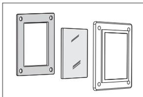
Plaats de afdichtring, het glas en het afdekplaatje weer terug.
