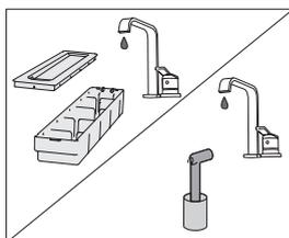
**3** Reinig het slangetje en het filter onder stromend water. Spoel het filter af tot er geen vuil meer op zit. Op die manier bent u verzekerd van een juiste werking van het apparaat en behouden gerechten hun verse smaak en geur.
