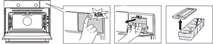
1. Öffnen Sie die Abdeckung des Wasserbehälters.
