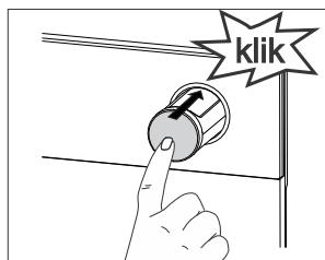
**1** Entfernen Sie den Wassertank aus dem Gehäuse, indem Sie den Knopf drücken. Wenn Sie den Knopf drücken, springt der Tank heraus.
