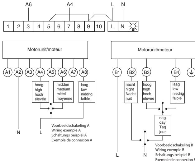
**Opmerking:** Deze schakeling levert in verband met het maximum aantal draden per buis een beperking van de mogelijkheden op (voeding van boven).
