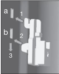
1. Insérez le crochet dans l'orifice (a).
