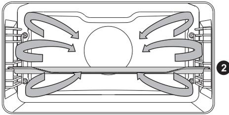
La résistance circulaire et le ventilateur fonctionnent simultanément.
