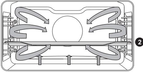
La résistance de sole, la résistance circulaire et le ventilateur fonctionnent en même temps. Ce mode convient aux pizzas et tartes aux fruits.
