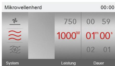
5. Wischen Sie mit einem Finger über das Touchpad, um die gewünschte Temperatur (im Modus „Mikrowellenherd + Umluft“ oder „Mikrowellenherd + Grill + Lüfter“) und die Leistung zu wählen. *Die gewählte Einstellung wird in Rot angezeigt.*
