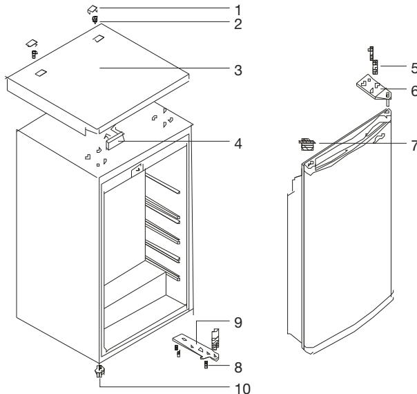
1. Entfernen Sie die Abdeckplatten (1) und die Schrauben (2).
