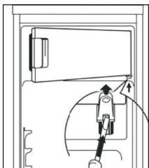
1. Öffnen Sie die Gefrierraumtür etwas. Drücken Sie mit einem kleinen Schraubendreher die Feder in die Öffnung des unteren Türlagers und entfernen Sie die Tür.
