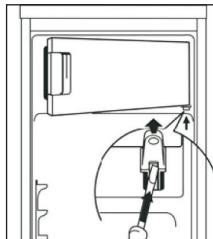
1. Entrebattez la porte du compartiment congélateur. À l'aide d'un petit tournevis, appuyez sur le ressort situé dans l'ouverture du coussinet inférieur de la porte et déboîtez-la.
