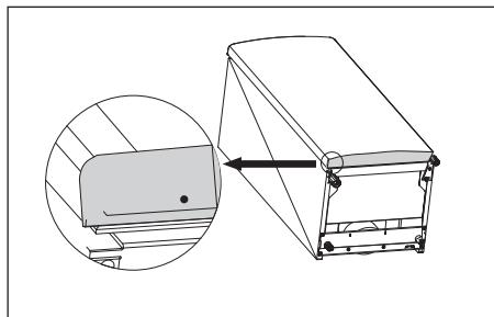
1. Kantel het toestel en zoek naar het schroefgat aan de linkerzijde van de onderkant.
