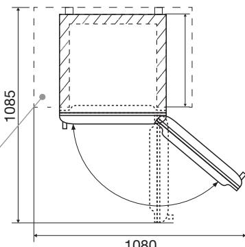
Prévoyez suffisamment d'espace autour de l'appareil pour permettre une ventilation et une circulation d'air correctes autour de celui-ci.
