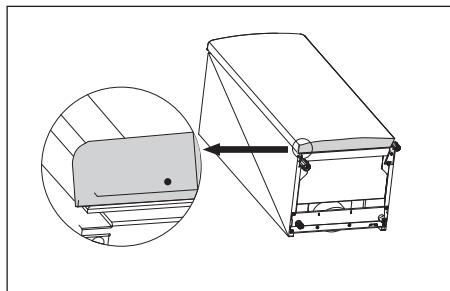
1. Basculez l'appareil et localisez le trou de vis en dessous à gauche.
