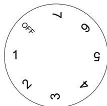
De thermostaat regelt automatisch de binnentemperatuur van het toestel.
