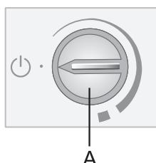
Pour arrêter l'appareil : tournez le bouton **A** en sens inverse et positionnez le curseur en face de l'icône  $\odot$  (l'appareil demeure sous tension, c'est-à-dire que le courant électrique est toujours présent).
