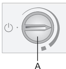
Pour mettre l'appareil en marche : tournez le bouton du thermostat **A** dans le sens des aiguilles d'une montre vers la partie large du symbole.
