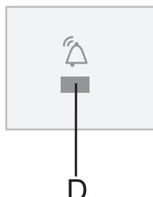
Si la température est trop haute à l'intérieur de l'appareil, une alarme se déclenche (le voyant D clignote).
