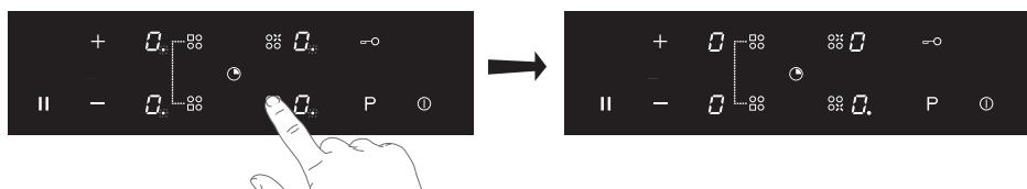
3. Wählen Sie mit „–“ und „+“ eine Leistungsstufe aus. Tippen Sie bei Bedarf auf die Boost-Taste, um die Boost-Leistung zu aktivieren.
