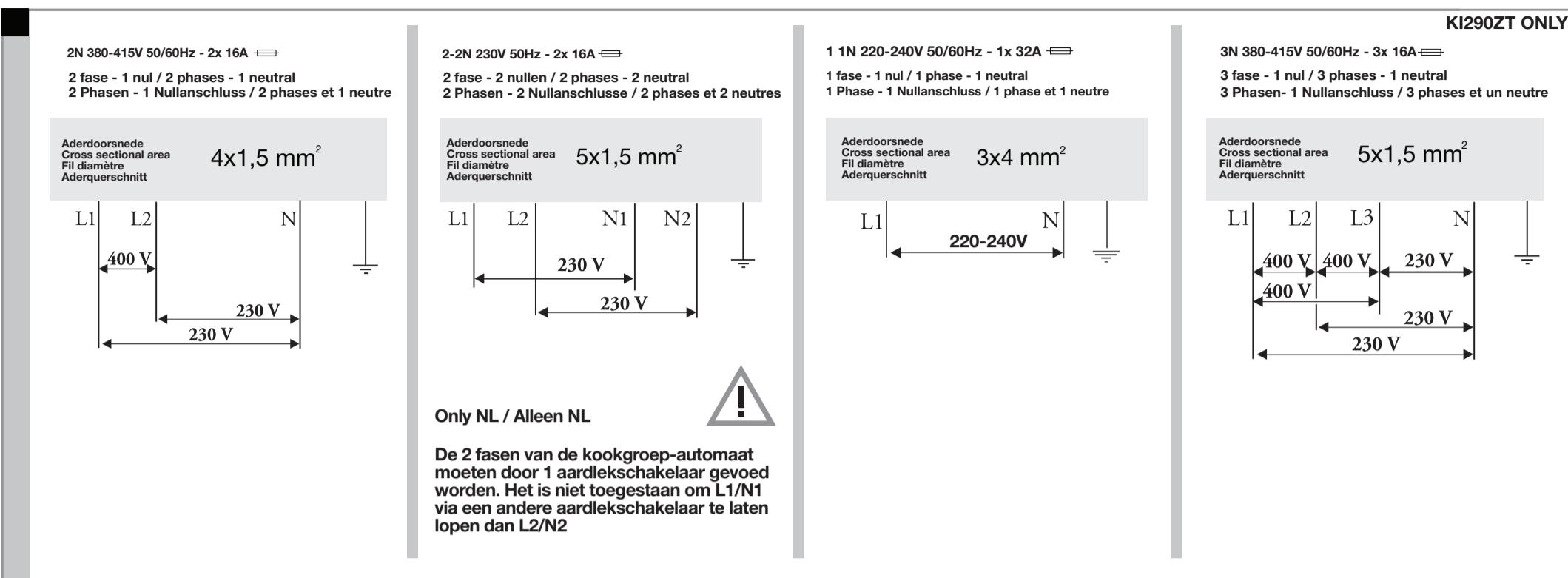
Raadpleeg de aansluitschema's op de achterzijde van het toestel/Maak de nodige doorverbindingen op het aansluitblok!
