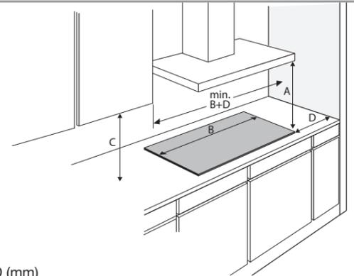
A (mm) min. 650    C (mm) min. 450    B(mm) min. 300    D (mm) min. 40
