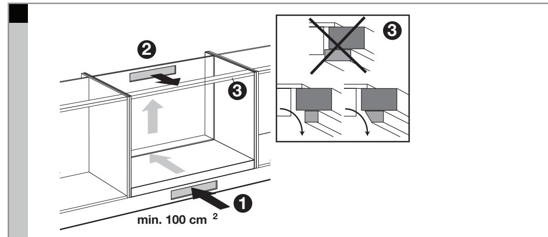
Als er een lade onder de kookplaat zit, is het noodzakelijk om een houten inzetstuk, bevestigd met schroeven, op een minimale afstand van 50 mm van de onderkant van de kookplaat te plaatsen.
