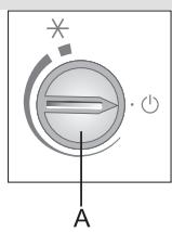
**Uitschakelen:** draai de knop **A** terug in de stand waarbij de pijl ter hoogte van het symbool **⊕** staat (het apparaat zal nog altijd worden gevoed, wat betekent dat er nog altijd elektrische stroom in het apparaat aanwezig is).
