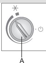
**Inschakelen:** draai de knop van de thermostaat **A** in de richting van de wijzers van de klok naar **het dikkere gedeelte van de markering**.
