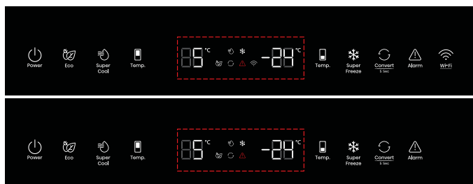
Elektronische Steuerung (an der Oberseite des Geräts) mit WiFi/ WLAN- Funktion
