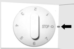
**Einschalten:** Drehen Sie den Thermostatknopf im Uhrzeigersinn zur Position 7.
