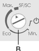
U schakelt het apparaat in door de knop (B) in de richting van **Max** te draaien. U schakelt het apparaat uit door de pijl (driehoekje) op de knop bij het AAN/UIT-teken te zetten (het apparaat staat nog steeds onder stroom).
