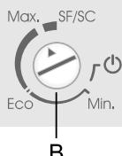
Pour mettre l'appareil en marche, tournez le bouton du thermostat (B) vers la position **Max** ; pour le mettre à l'arrêt, positionnez le curseur en face de l'icône Marche/Arrêt (l'appareil est à l'arrêt, mais il demeure sous tension).
