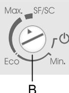
Durch Drehen des Knopfes (B) in Richtung Min. auf Max. wird das Gerät eingeschaltet. Das Gerät wird abgeschaltet, wenn das Dreieck auf dem Knopf auf die Markierung ON/OFF ⏪ zeigt (das Gerät steht noch immer unter Spannung).
