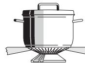
**Goed:** De warmte wordt gelijkmatig over de panbodem verdeeld.
