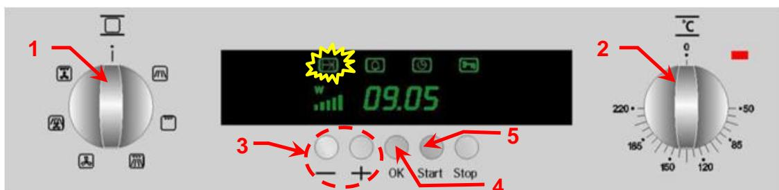
1. Tournez le **sélecteur de fonction** pour le positionner sur la fonction Air chaud . Le **voyant d'indication du temps de fonctionnement** clignote.
