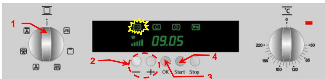
1. Tournez le **sélecteur de fonction** pour le positionner sur la fonction Gril + convection . Le **voyant d'indication du temps de fonctionnement** clignote.
