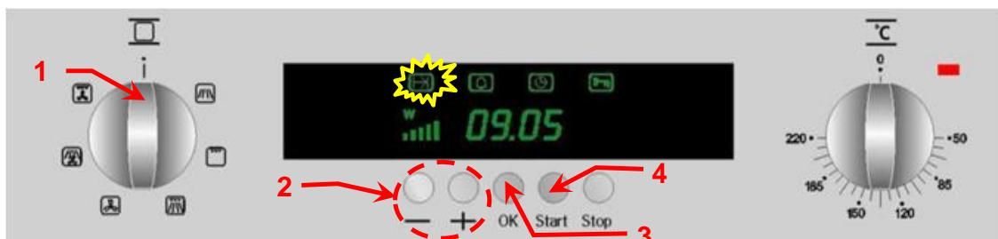
1. Draai de **functieschakelaar** op de grill + ventilatorfunctie . De Bereidingstijdindicator knippert nu.
