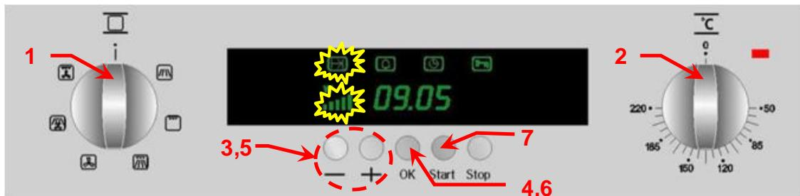
1. Tournez le **sélecteur de fonction** pour le positionner sur la fonction Micro-ondes + air chaud . Le **voyant d'indication de puissance** clignote.
