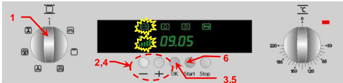
1. Draai de **functieschakelaar** op de magnetronfunctie De **vermogensindicator** knippert.
