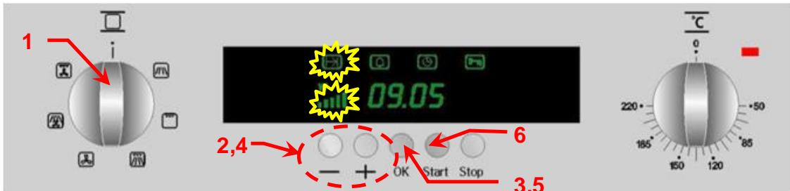
1. Draai de **functieschakelaar** op de magnetron + grillfunctie
