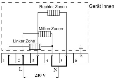
Mit den auf der Anschlussleiste vorhandenen Brücken können die erforderlichen Verbindungen hergestellt werden, wie in obigen Illustrationen angegeben. Im Deckel des Anschlusskastens und in untenstehender Illustration ist angegeben, wie die Brücken anzubringen sind. Sie sind nicht unmittelbar über den Anschlussdrähten anzubringen, sondern zwischen dem Schraubenkopf und der Klemme um den Anschlussdraht.
