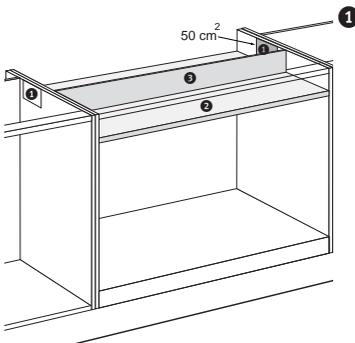
1 Zaag de beluchtingsopening(en) uit zodat de totale oppervlakte van de gaten minimaal  $100 \text{ cm}^2$  is. Zie bijvoorbeeld figuur met twee gaten van  $50 \text{ cm}^2$ .
