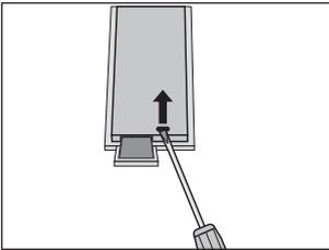
An der Unterseite des Gerätes befindet sich ein Etikett mit den Schaltbildern. Die Anschlussklemmen sind nach Öffnen des Anschlusskastens an der Unterseite erreichbar. Öffnen Sie den Deckel des Anschlusskastens mit einem Schraubendreher.
