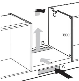
Avec un four, il faudra effectuer à l'avant une fente d'au moins 6 mm. Découpez à la scie les ouvertures d'aération "A" + "B" (100 cm<sup>2</sup>).
