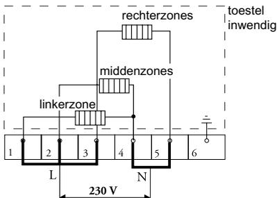
Met de op het aansluitblok aanwezige bruggen kunt u de vereiste doorverbindingen maken zoals in voorgaande illustraties staat aangegeven. In het deksel van het aansluitkastje en in onderstaande illustratie staat aangegeven hoe u de bruggen aan moet brengen. Deze moeten niet meteen bovenop de aansluitdraden worden geplaatst, maar tussen de schroefkop en de klem om de aansluitdraad.
