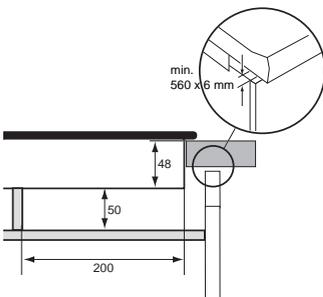
3 Sorgen Sie zur Abschirmung des Luftstroms für eine Abschirmblende zwischen der Abschirmplatte und dem Kochfeld aus dem gleichen Material wie die Abschirmplatte. Belüftung erfolgt über die daneben befindlichen Schränke.
