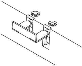
Attachez le câble en utilisant le dispositif de délestage.
