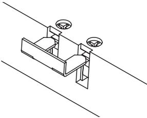
Befestigen Sie das Kabel mit der Zugentlastung und schließen Sie den Deckel.
