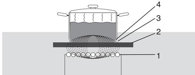
In het toestel wordt een magnetisch veld opgewekt. Door een pan met een ijzeren bodem op een kookzone te plaatsen ontstaat in de panbodem een inductiestroom. Deze inductiestroom wekt warmte op in de panbodem.
