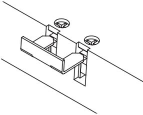
Zet de kabel vast met de trekcontlasting en sluit het deksel.
