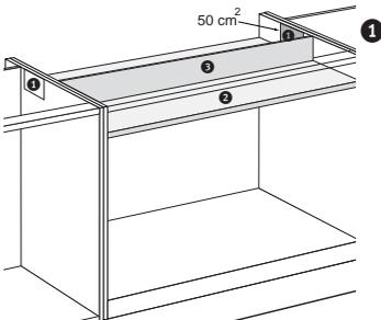
1 Sägen Sie die Belüftung(s)öffnung(en) aus, so dass die Gesamtfläche der Öffnungen minimal 100 cm<sup>2</sup> beträgt. Siehe hierzu z.B. Abbildung mit 2 Öffnungen von je 50 cm<sup>2</sup>.
