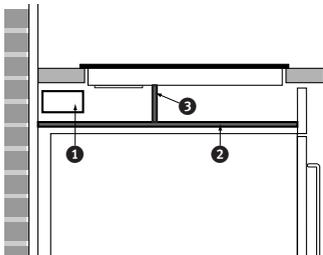
2 Plaats een schermplaat tussen de oven en de kookplaat. De plaat moet minimaal 10 mm dik zijn en hittebestendig ( $85 \text{ }^\circ\text{C}$ ). De ruimte tussen de onderzijde van de kookplaat en schermplaat moet minimaal 50 mm bedragen.
