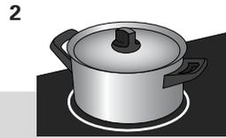
Induktionskochen ist äußerst sicher. Da die Wärme im Topf erzeugt wird und die Glasplatte nicht heißer werden kann als der Topfinhalt, ist es kaum möglich, daß Sie sich an dem Gerät verbrennen. Jedoch gibt es, wie bei jedem Elektrogerät, einige Dinge, die Sie beachten sollten.
