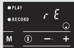
Im Display sehen Sie nach einigen Sekunden abwechselnd die eingestellte Stufe und "rE". Die Kochzeiten und Stufen werden beim Kochen automatisch abgespeichert.
