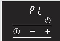
In het display ziet u na enkele seconden afwisselend de ingestelde stand en "PL".
