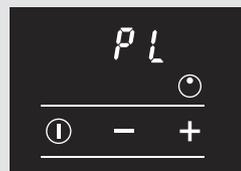
Sur l'écran, apparaissent en alternance l'allure de chauffe sélectionnée et la mention "PL".
