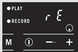
In het display ziet u na enkele seconden afwisselend de ingestelde stand en "rE". De kooktijden en standen worden tijdens het koken automatisch bewaard.
