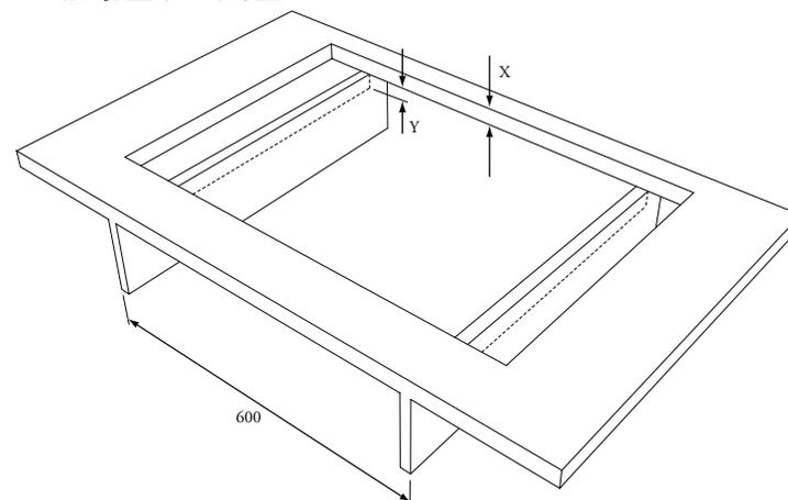
dimensions d'encastrement HG76/77/96/97..MX/MT et HG96..SX/ST dans corpus de 60 cm
