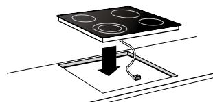
Fixez la plaque de cuisson à l'aide des bornes remises avec la livraison. En cas de plans de travail plus fins que 40 mm, utilisez un bloc de garniture entre les bornes et le plan de travail. Vissez les vis dans les trous bosselés.
