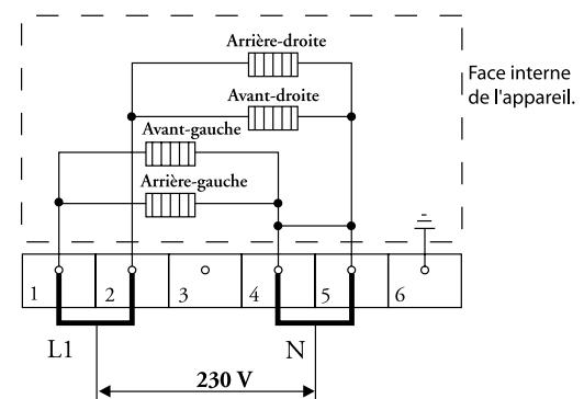
**Connexion 2 phases avec 2 neutres (2 2N a.c. 230 V / 50 Hz):**
