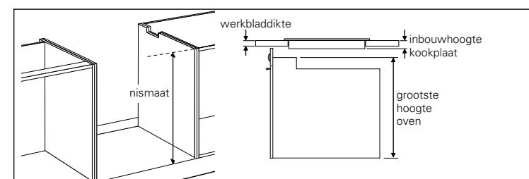
**Boven een 90 cm oven of een oven van een ander merk die niet is voorzien van mantelkoeling.**
