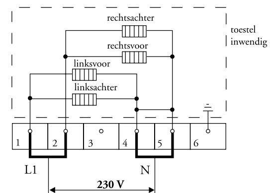
**2 fasen met 2 nullen aansluiting (2 2N a.c. 230 V / 50 Hz):**
