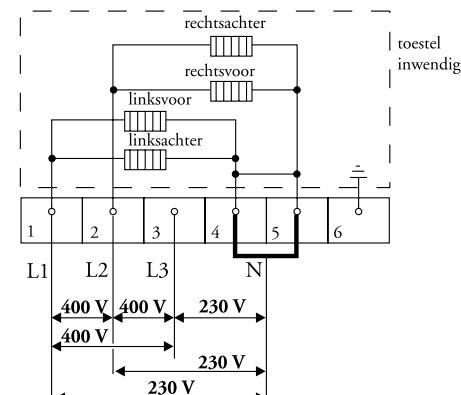
**3 fasen aansluiting (3 a.c. 230 V / 50 Hz):**
