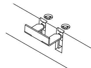
Zet de kabel vast met de trekontlasting en sluit het deksel.
