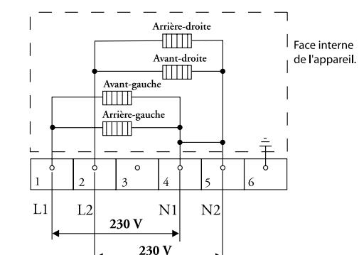
**Connexion 2 phases avec 1 neutre (2 1N ca 400 V / 50 Hz) :**
