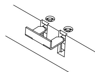
Attachez le câble en utilisant le dispositif de délestage. Fermez ensuite le couvercle.
