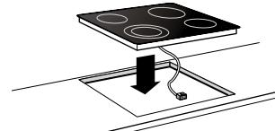
Befestigen Sie das Kochfeld mit den mitgelieferten Klemmen. Bei Arbeitsplatten, die dünner als 40 mm sind, ist ein Füllholz zwischen den Klemmen und der Arbeitsplatte zu verwenden. Die Schrauben sind in die durchgedrückten Löcher zu schrauben.
