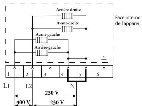
**Connexion 3 phases avec 1 neutre (3 1N ca 400 V / 50 Hz) :**
