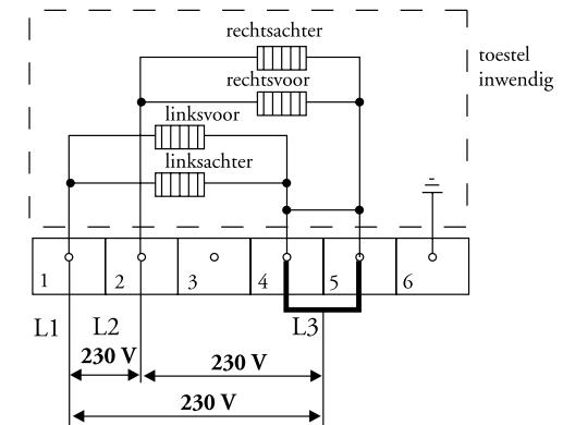
Met de op het aansluitblok aanwezige bruggen kunt u de vereiste doorverbindingen maken zoals in voorgaande illustraties staat aangegeven. In het deksel van het aansluitkastje en in onderstaande illustratie staat aangegeven hoe u de bruggen aan moet brengen. Deze moeten niet meteen bovenop de aansluitdraden worden geplaatst, maar tussen de schroefkop en de klem om de aansluitdraad.
