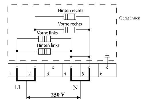
**2-Phasen-Netzanschluss mit 2 Nulleitern****(2 2N Wechselstrom 230 V / 50 Hz):**
