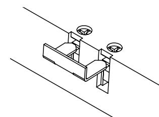
Befestigen Sie das Kabel mit der Zugentlastung und schließen Sie den Deckel.
