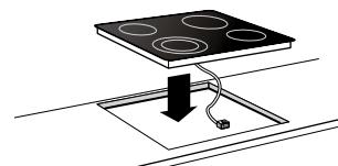
Zet de kookplaat vast met behulp van de bijgeleverde klemmen. Bij werkbladen die dunner zijn dan 40 mm moet er een opvulblokje tussen de klemmen en het werkblad worden gebruikt. De schroeven moeten in de doorgedrukte gaten geschroefd worden.
