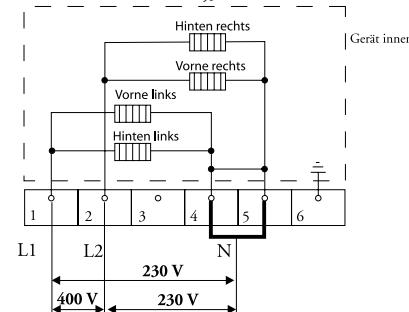
**3-Phasen-Netzanschluss mit 1 Nulleiter (3 1N Wechselstrom 400 V / 50 Hz):** Die Spannung zwischen den Phasen und dem Nullleiter ist 230 V Wechselstrom. Zwischen den Phasen steht eine Spannung von 400 V. Sorgen Sie für eine Verbindungsbrücke zwischen den Anschlussstellen 4-5. Phase 3 wird nicht belastet. Ihre Gruppen müssen mit minimal 16 A (2 Sicherungen) abgesichert sein. Das Anschlusskabel muss einen Aderdurchmesser von mindestens 2,5 mm<sup>2</sup> haben.
