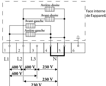
**Connexion 3 phases (3 ca 230 V / 50 Hz) :**
