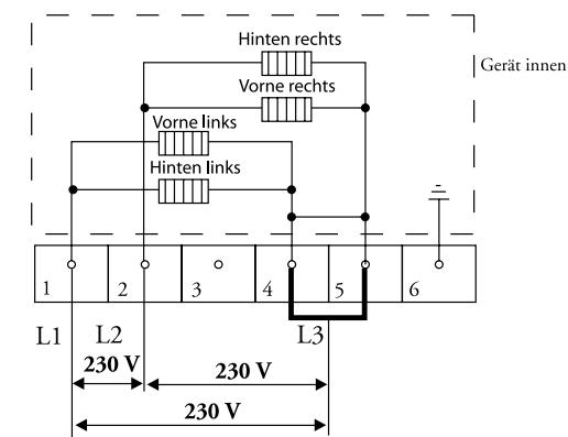
Mit den auf der Anschlussleiste vorhandenen Brücken können die erforderlichen Verbindungen hergestellt werden, wie in obigen Illustrationen angegeben. Im Deckel des Anschlusskastens und in untenstehender Illustration ist angegeben, wie die Brücken anzubringen sind. Sie sind nicht unmittelbar über den Anschlussdrähten anzubringen, sondern zwischen dem Schraubenkopf und der Klemme um den Anschlussdraht.
