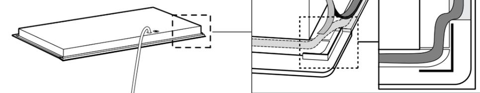
1. Plak de bijgeleverde afdichtband in de rand aan de onderzijde van de glasplaat en het beluchttingsprofiel.
