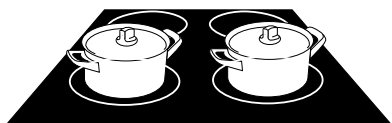
Fig. 6 : Les foyers placés l'un à côté de l'autre peuvent être réglés simultanément sur la position 9
