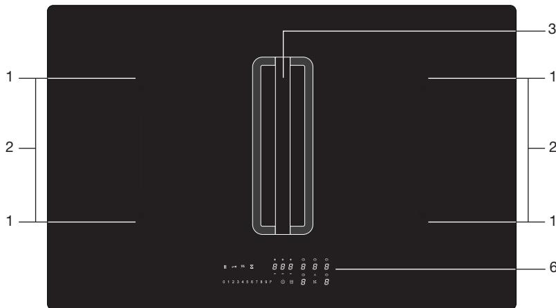
1. Zone de cuisson octa 210 x 190 mm / 2,1 kW (boost 3,0 kW)
