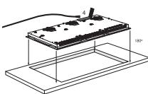
Das Gerät mit der Unterseite nach oben auf die Anrichte legen.
