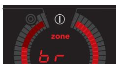
Eine Zone mit einer „Brücke“ zwischen den Elementen ist eine Brückenzone. Beide Zonen können entweder getrennt oder gleichzeitig verwendet werden. Wenn die Zonentaste für eine der beiden Zonen gedrückt wird, werden beide Zonen durch das Brückenelement miteinander verbunden. Jetzt ist eine große Kochzone aktiviert. Das Bedienfeld der gedrückten Zonentaste kann jetzt dazu verwendet werden, die gesamte Brückenzone zu steuern. Das andere Bedienfeld zeigt nur die gewählte Einstellung an.
