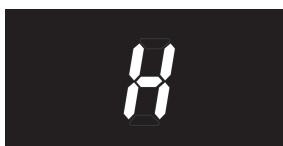
*Na intensief gebruik van een kookzone kan de gebruikte zone nog enkele minuten warm blijven. Zolang de kookzone warm is, blijft er een "H" in het display staan.*
