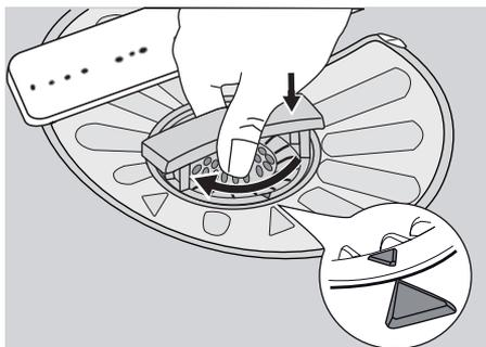
8. Zet filter (A) in filter (B) op zijn plaats.
