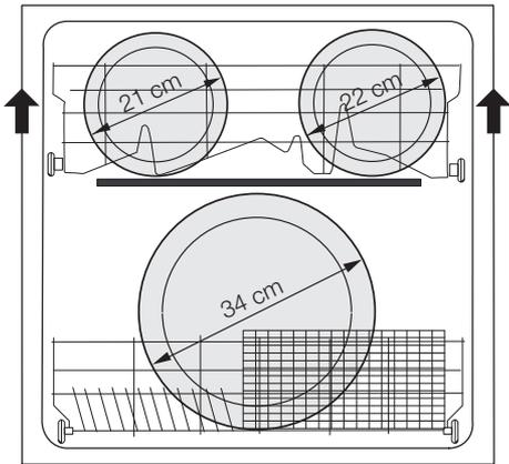
2. Heben Sie den Korb auf beiden Seiten vorsichtig an, bis der Mechanismus einrastet und der Korb stabil ist.
