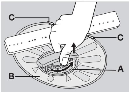
2. Filter (A) heeft twee delen. Haal de twee delen uit elkaar om het filter te demonten.
