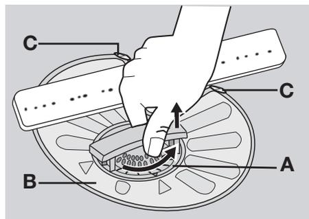
2. Le filtre (A) est constitué de deux pièces. Pour démonter le filtre, séparez-les.
