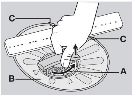
2. Filter (A) besteht aus zwei Teilen. Ziehen Sie diese auseinander, um sie zu zerlegen.
