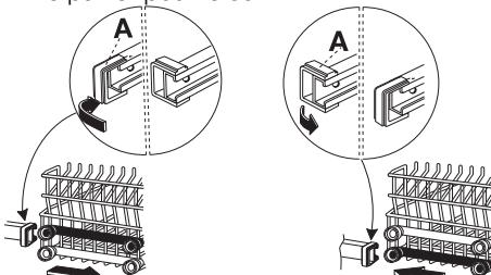
2. Glissez le panier dans la position la plus haute et replacez les butées (A) dans leur position d'origine.
