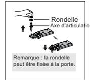
7. Suivez l'étape 5 dans le même ordre, en plaçant l'élément ① sur la droite et l'élément ② sur la gauche, puis fixez-les au moyen de vis ④. Installez enfin l'élément ③.
