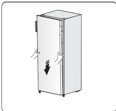
9. Transférer la partie supérieure de la charnière, introduire l'axe de la charnière supérieure dans le trou supérieur de la porte et ajuster la position de la porte (en la maintenant avec la main), en fixant la partie supérieure de la charnière avec les vis auto-taraudeuses spéciales de la bride.
