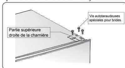
3. Retirez l'axe supérieur de la charnière, transférez-le sur le côté renversé et serrez-le fermement, puis placez-le dans un endroit sûr.
