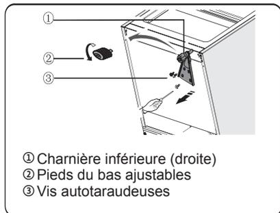
7. Replacer la partie inférieure de la charnière vers la gauche et la fixer avec les vis auto-taraudeuses spéciales de la
