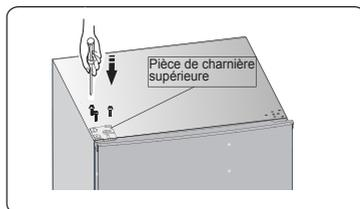
10. Installez le couvercle du trou de vis dans le coin supérieur droit du réfrigérateur. Installez le cache-charnière (qui se trouve dans le sac en plastique) dans le coin gauche. Mettez l'autre cache-charnière dans le sac en plastique.
