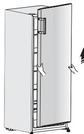
5. La placer sur une surface lisse avec le panneau vers le haut. Desserrez la vis ② et la pièce ①, puis installez-les sur le côté gauche et serrez-les fermement.
