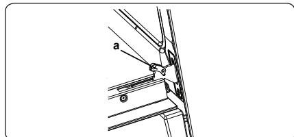
1. Öffnen Sie die Tür vollständig und drehen Sie die Sperrklinken so weit wie möglich zurück.
